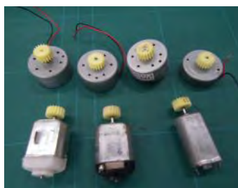
上排：光碟機拆下的馬達 下排：玩具馬達
