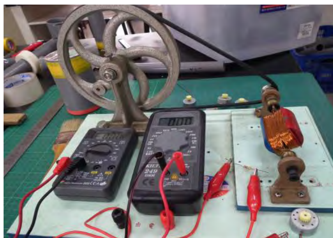
改裝學校的發電機以測試馬達發電效率
