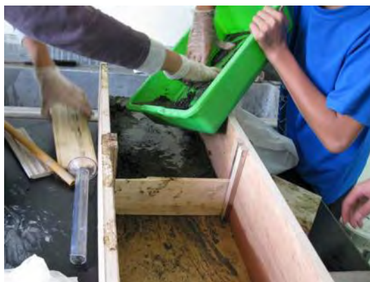
鋪設水槽泥沙
