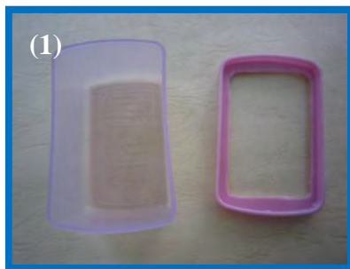
圖 4-11 內盒的製備 圖(1)內盒的底部，需預留小孔方便導線進出。圖(2)先將上方的蓋子割成中空，方便扣住質子交換膜
