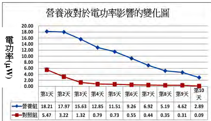
圖 5-11 營養液對電功率影響的變化圖 營養組的電功率一直都比對照組高，而且在第 10 天還維持有 2.89 \mu w 的功率，但對照組僅剩下 0.09 \mu w。
