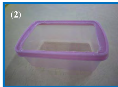
圖 4-11 內盒的製備 圖(1)內盒的底部，需預留小孔方便導線進出。圖(2)先將上方的蓋子割成中空，方便扣住質子交換膜
