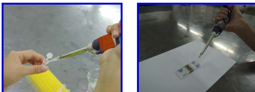
圖 4-18 藻液的連續稀釋以及血球計數器的使用
