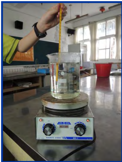
圖 4-9 質子交換膜的軟化 將質子交換膜置於 80°C 的水中加熱 30 分鐘
