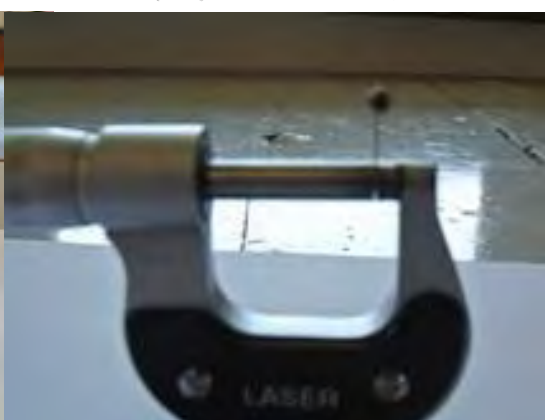
圖(六) 測量肋後厚度
