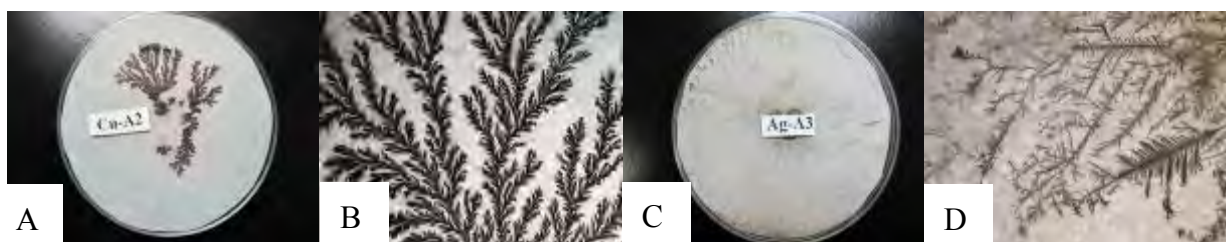
圖四、銅樹與銀樹在濾紙上沉積之比較濾紙上析出的銅樹（A）、銀樹（圖一 C）；顯微鏡下的銅樹（B）、銀樹（D）。
