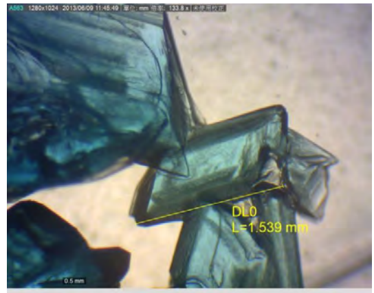
↑圖 5-11 對照組顯微鏡下結晶。結晶為平行四邊形，並且互相重疊。
