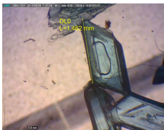
↑圖 5-44 振幅 500cm，頻率 500Hz 顯微鏡下結晶。結晶為平行四邊形，有互相連結且輕微重疊狀況。
