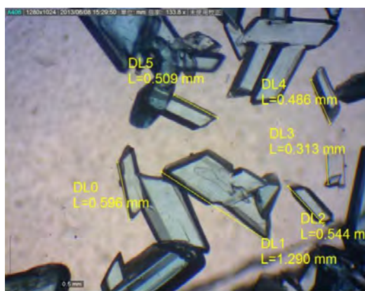
↑圖 5-50 振幅 100cm，頻率 1000Hz 顯微鏡下結晶。結晶為平行四邊形及長條形，並且互相重疊。
