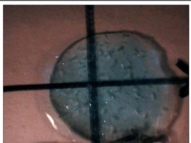
圖 5-1-2 底部結晶成形，液滴表面長出零散的第二層結晶，結晶環繞偏外圍部分生長。
