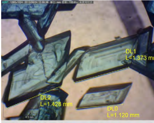
↑圖 5-36 振幅 400 公分，頻率 500Hz 顯微鏡下結晶。結晶為平行四邊形，有些較小的結晶與其重疊。
