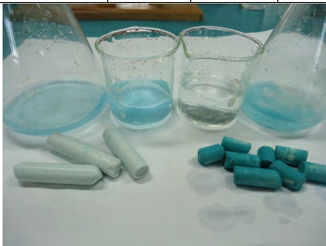
圖片 D：硫酸鈣粉筆、無灰碳酸鈣粉筆對硫酸銅的吸附作用
