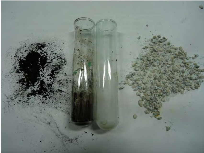
圖片 E：碳酸鈉、硫酸銅生成的藍綠色沉澱加熱後變黑(左)， 大理石硫酸銅晶體混合後加熱(右)
