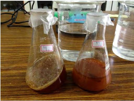
圖 64:實驗 48 完全凝固, 實驗 49 大部分凝固
