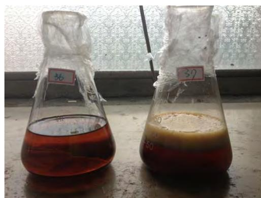
圖 53:實驗 37 轉酯化反應後產生皂化
