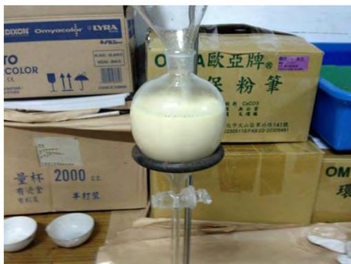
圖 57:實驗 40 水洗後產生皂化
