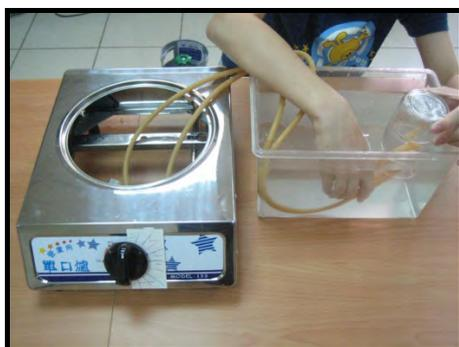
圖 9：用排水集氣法量到的瓦斯爐流量
