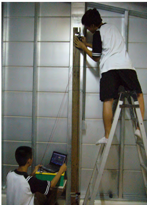
圖：實際測量波速改成直立擺放。
