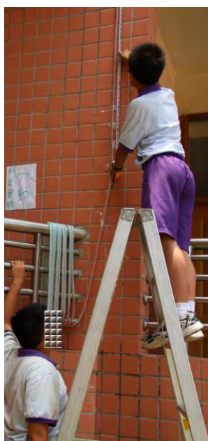
圖二十五 測量水位高與各圈水位差及第一圈氣泡大小
