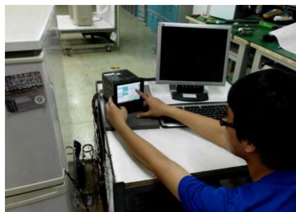
圖 4.34 紀錄資料擷取器測得的溫度
