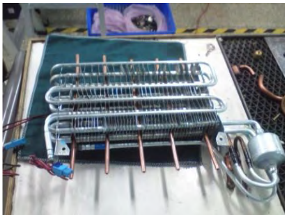
圖 4.20 將水側銅管在蒸發器上排好
