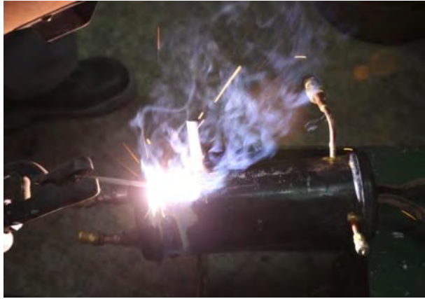
圖 4.18 將儲熱水桶的瓶身及上蓋 使用電銲示意圖
