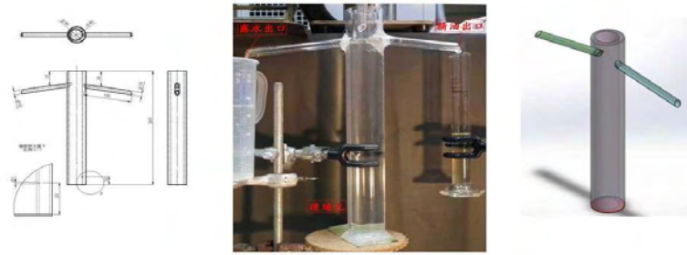
圖 24 自製自動油水分流器設計圖及成品圖
