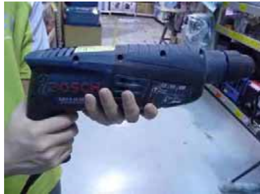
BOSCH 輕型鎚鑽 GBH2-18RE 直徑：43.45mm 厚度：23.4mm
