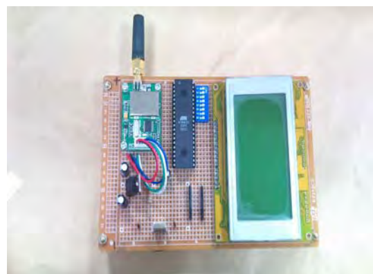
圖 4-10 校園 BBCall 接收電路
