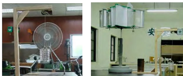
圖 27 風車拉動負載計算輸出功率
