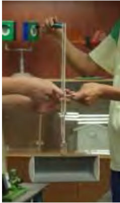
圖 8 測量阻力型葉片正向及逆向受力
