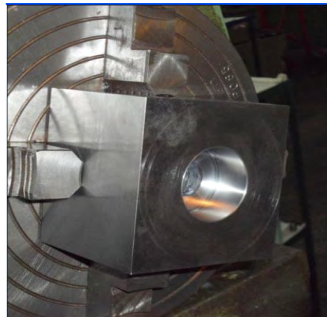
(圖二 鑽孔完成)
