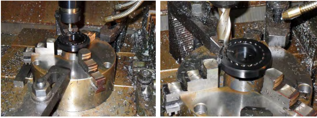
圖 10(a) 切削中心機加工 3D 立體凸輪及基座
