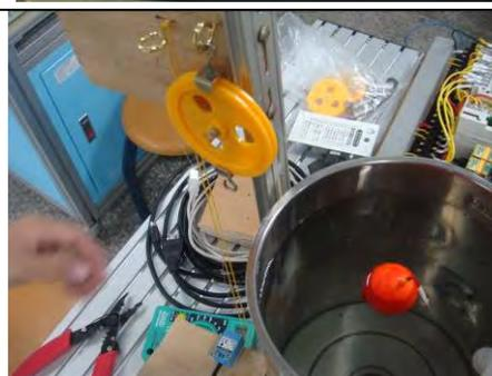
6. 測試時又發現第 1 加熱桶沒有蓋子加熱速度會很慢，且導致溫度無法達到 100 °C，但蓋子又會引響到滑輪線，所以就將蓋子用砂輪機磨出一個缺口之後再做測試，溫度就可以正常升高了。
