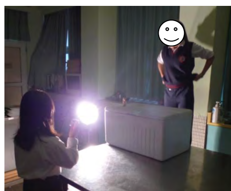
每一分鐘從觀測孔觀測溫度計，記錄光照五分鐘的溫度變化。
