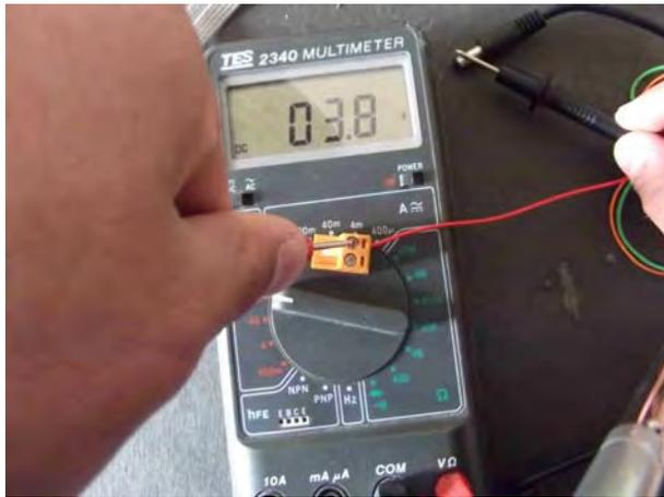
圖 8.雷射二極體工作電壓
