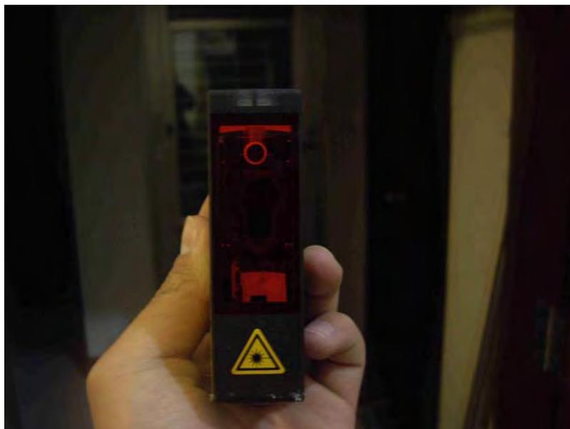
圖 1.雷射測距儀
