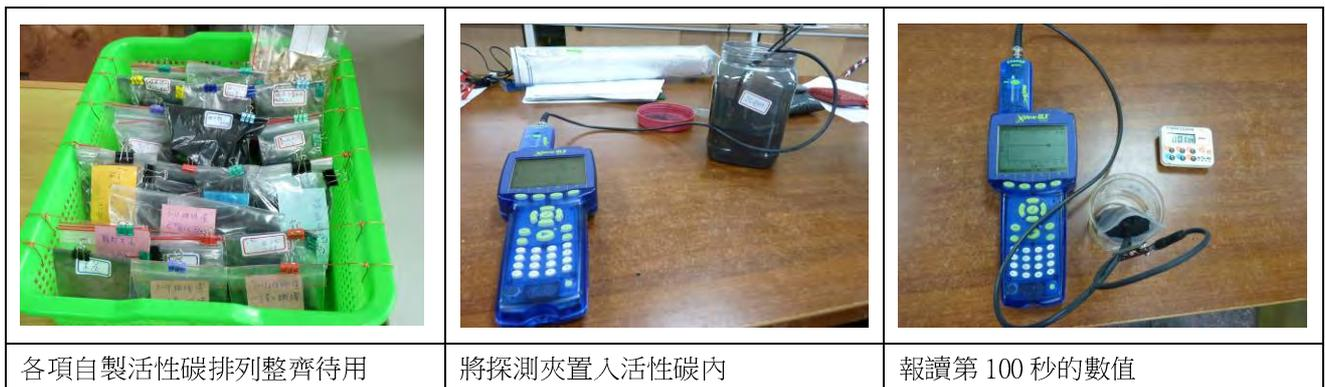
圖 5-11 電壓測量步驟
