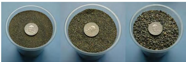
圖 8 實驗 8 實驗使用的三種粗細砂子
