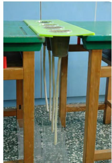
圖 9 實驗 8 聚酯纖維棒與粗棉繩輔助吸水實驗
