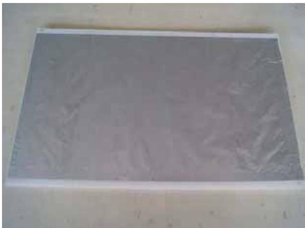
圖 6-1 DIY 製作鋁箔紙反射板
