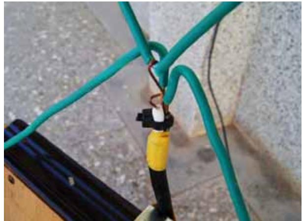
圖 2-2 DIY 天線連結至同一條同軸電纜
