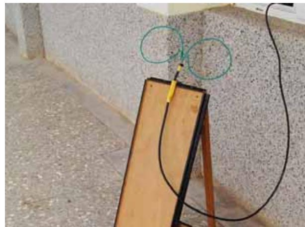
圖 4-2 圓形銅製天線實驗情形
