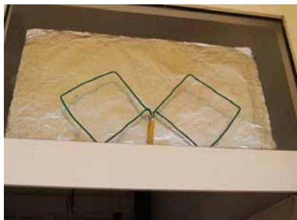
圖 7-2 安裝天線和鋁箔紙板
