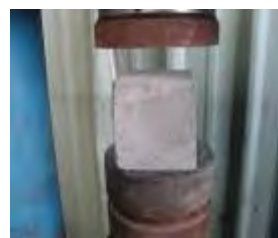
5cm×5cm×5cm 混凝土試體
