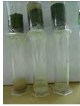
不同粒徑砂土滲水情形
