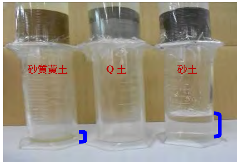
滲水速度砂土 > 砂質黃土 > Q土
