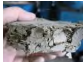
加15克稻梗的土塊 強烈擠壓不容易散裂
