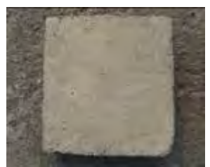
20cm×20cm×5cm 混凝土試體
