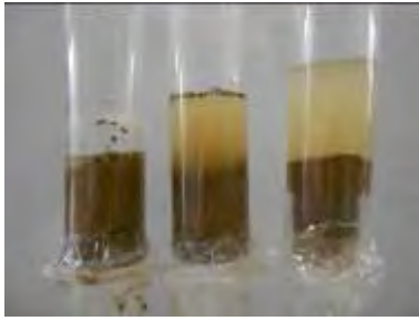
不同粒徑砂質黃土滲水情形
