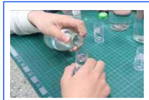
將鐵釘浸泡在模擬雨水中
