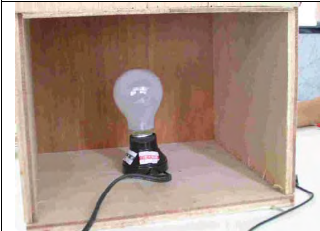
圖 17. 基座安裝鎢絲燈泡的燈座
