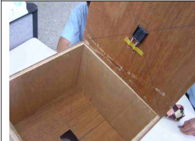
圖 15. 頂蓋裝上太陽能發電光板
