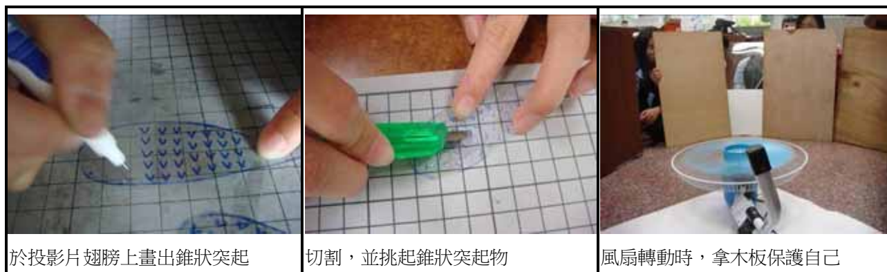
圖 4 - 25 切割翅面針狀做空氣摩擦實驗
