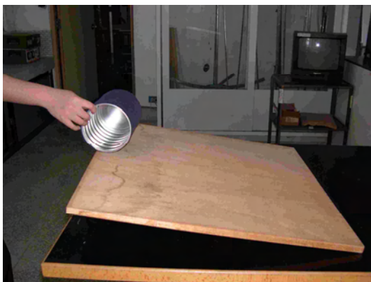
圖十四 貼上布料之奶粉罐從斜坡(角度 5°)頂端滾落
