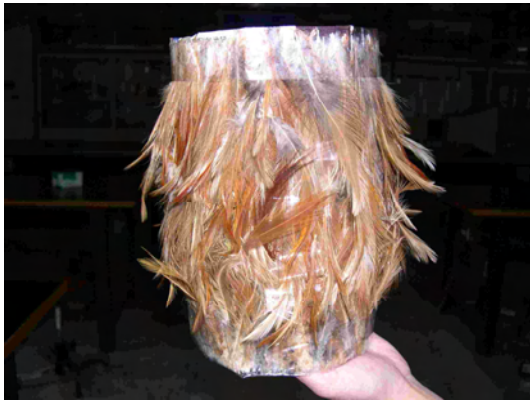
圖十二 測試布料--雞毛(No.7)固定於奶粉罐外側
