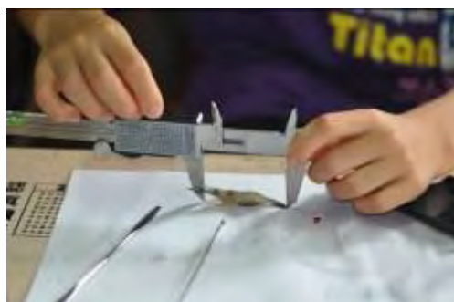
圖 39 用游標尺測量全長
