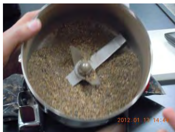
圖 1：利用粉碎機粉碎菱角殼，再用電子顯微鏡量得為長度約為 0.003mm。
