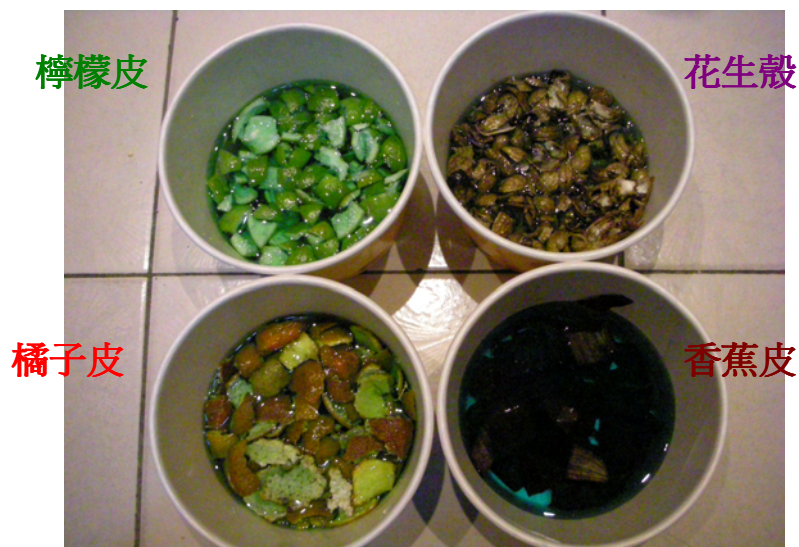
圖二 橘子皮、檸檬皮、香蕉皮與花生殼吸附重金屬污染水的裝置
