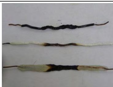
圖四十三：燃燒後的電線 由上而下分別為一般電線、樹脂電線、膠水電線
