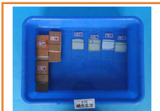
圖 10 放入鹼性溶液內，浸泡 10 分鐘
