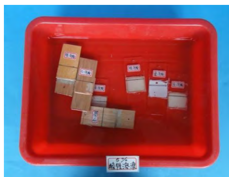
圖 11 放入酸性溶液內，浸泡 10 分鐘
