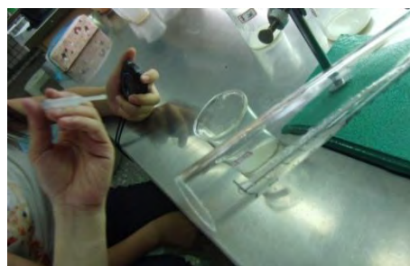
圖 9 以計時器測量滴下後流動時間
