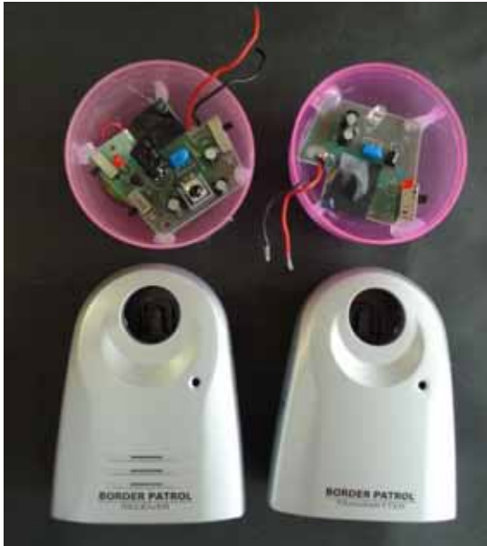
圖33 將來客報知器的「發射器」與「接收器」拆開分別放入扭蛋盒中
