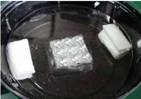
圖12 光源上方加一層塑膠片，避免光源髒污
