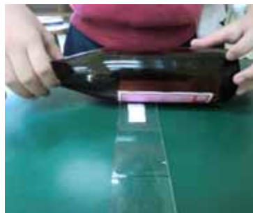
圖22 玻璃瓶壓去多餘水份
