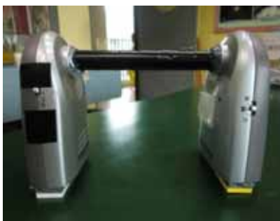
圖39 使用黑吸管使紅外線光束集中。
