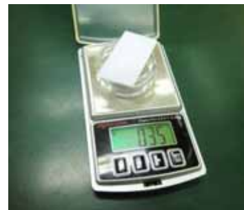
圖23 秤重並調整試片含水量
