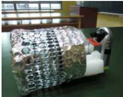
圖40 以烤肉網製成透氣外殼，熱氣才能進、出。
