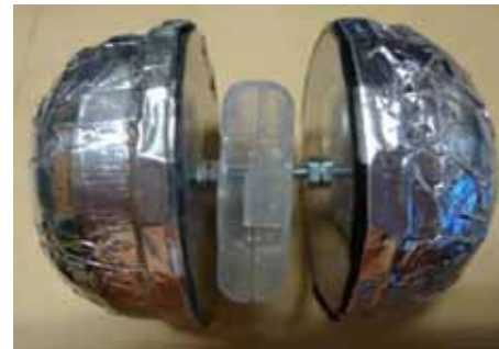
圖34 利用螺絲連接可旋式置紙盒與發射接收器，並用鋁薄膠帶包覆。
