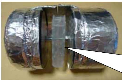
圖33 將來客報知器的「發射器」與「接收器」拆開分別放入扭蛋盒中
