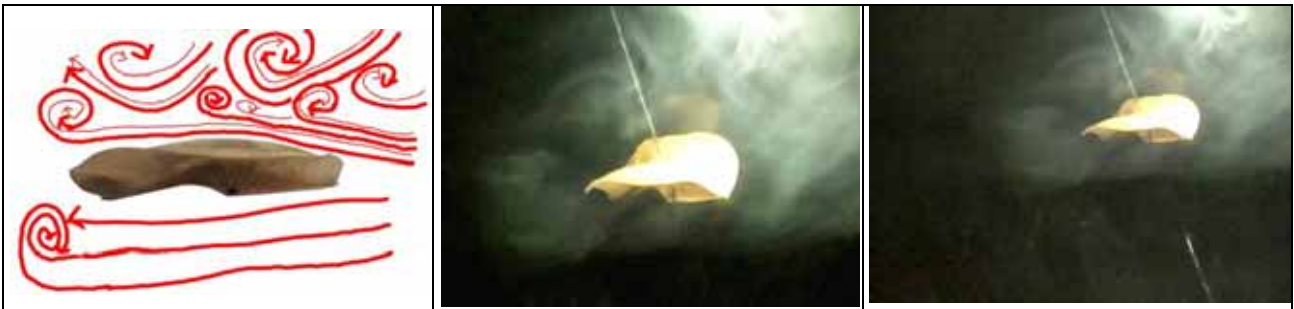
小上反角正面迎風，上半部產生許多渦流，翼尾上方渦流下壓蒴果尾部，加上前上方氣流密集壓力小使蒴果將側翻
