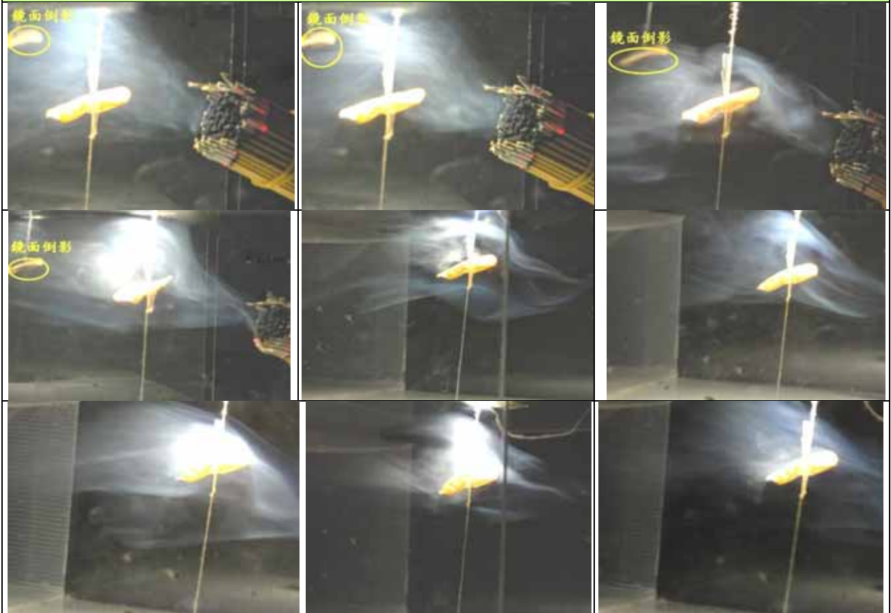
大上反角側面迎風，上方氣流更密集速度快壓力小使蒴果上揚，又同時產生渦流下壓，和翼面升力對抗，開始搖擺。
