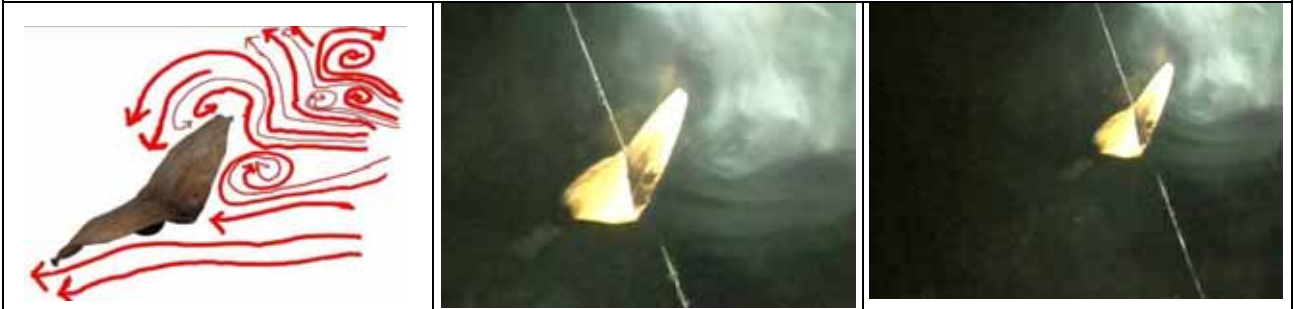
大上反角側面迎風，上方氣流更密集速度快壓力小使蒴果上揚，又同時產生渦流下壓，和翼面升力對抗，開始搖擺。
