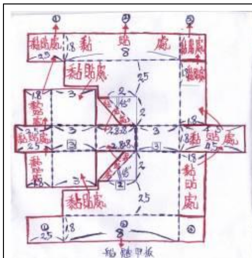
(圖 13) 前擋風玻璃傾斜角為 45 的船上建築物展開圖：長度 8(3+2+3) 公分、寬度為 1.8 公分、高度為 4.5 公分。
