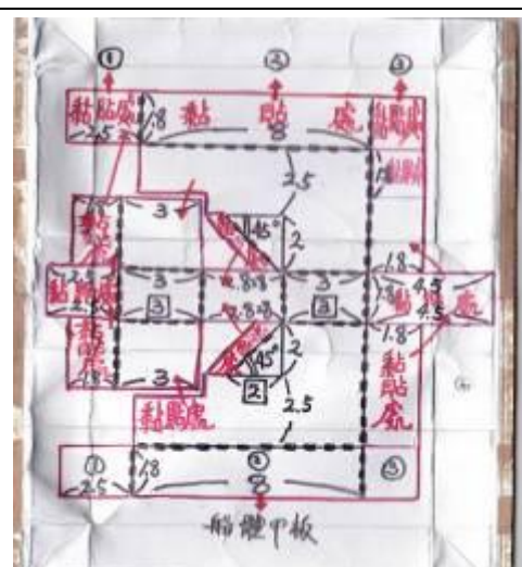
(圖 13) 前擋風玻璃傾斜角為 45 的船上建築物展開圖(鋁箔紙)：長度 8(3+2+3) 公分、寬度為 1.8 公分、高度為 4.5 公分。
