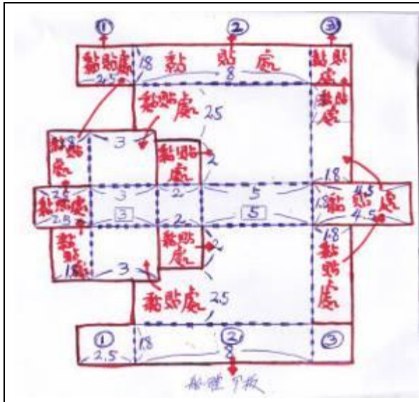
（圖 1）前擋風玻璃傾斜角為 90 度的船上建築物展開圖：長度 8 (3+5)公分、寬度為 1.8 公分、高度為 4.5 公分。
