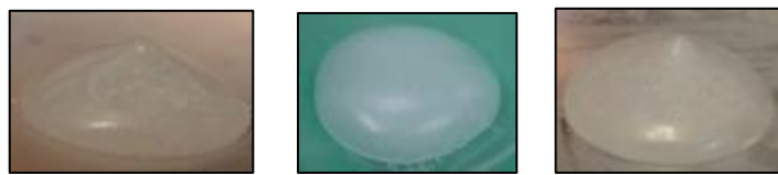
有尖凸的結冰過程中，水珠內部溫度有明顯的過冷現象（左圖）；反之，則在零度 C 停留很久溫度再往下降。（右圖）
