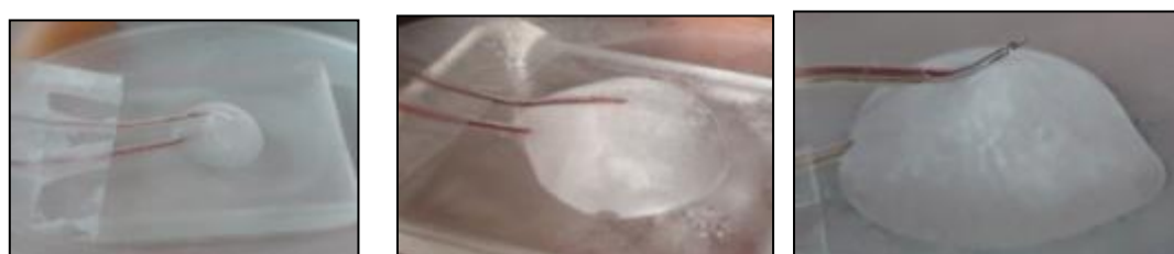
我們以熱電偶測量水珠的底部、頂部或上方的溫度。
