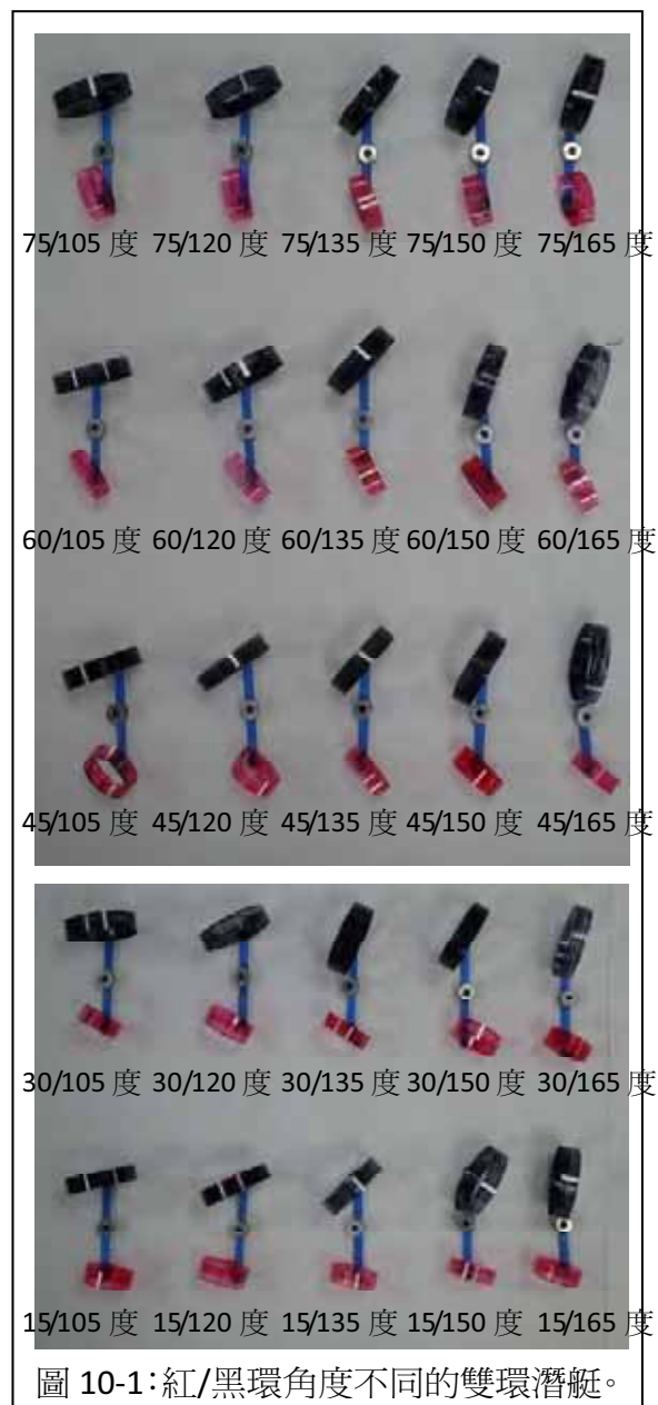
圖 9-4：雙環潛艇環與管身的角度與其漂移時前中後段管身潛艇紅/黑環角度為 45 度/135 度、90 度/135 度時會產生旋轉，且其前中後的平均角度不僅接近也偏低，所以漂移時間也較長；而紅環/黑環的角度為 45 度/90 度時也會產生旋轉，雖前段平均角度偏低，但中、後段平均角度大大增加，使得下降速度也增快。
