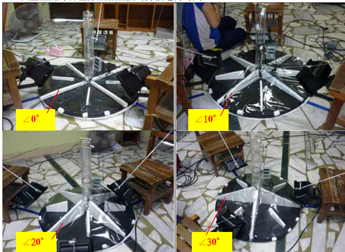
圖九、不同集熱棚底角之太陽能塔
