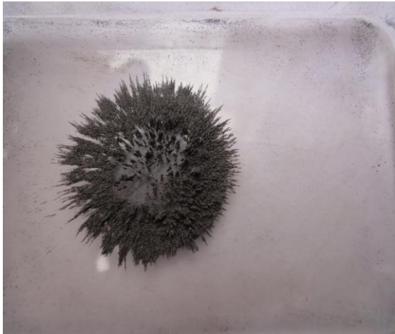
圖七、圓形磁鐵的磁力線分佈全面均勻 圖八、圓形磁鐵的磁力全面均勻 結果：圓形磁鐵的磁力線分佈全面均勻，如圖七；磁力一樣大，如圖八。
