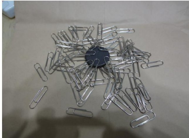
圖七、圓形磁鐵的磁力線分佈全面均勻 圖八、圓形磁鐵的磁力全面均勻 結果：圓形磁鐵的磁力線分佈全面均勻，如圖七；磁力一樣大，如圖八。
