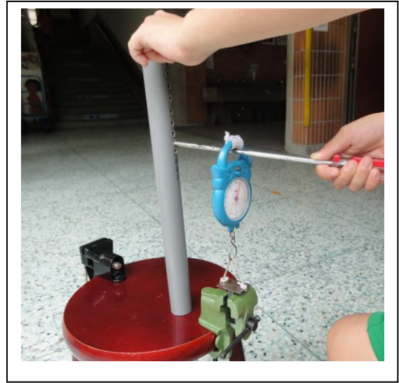
圖十二 鋁合金（黑色）、鑄鐵（淺綠色）虎鉗夾住兩側加鐵片的磁鐵，再以槓桿原理量測情形
