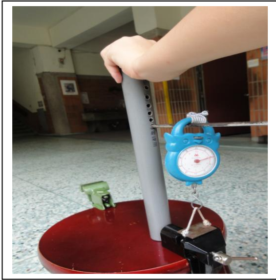
圖十二 鋁合金（黑色）、鑄鐵（淺綠色）虎鉗夾住兩側加鐵片的磁鐵，再以槓桿原理量測情形
