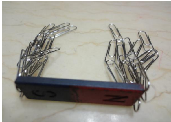
圖一、長條形磁鐵的磁力線分佈在兩端最多 圖二、長條形磁鐵的磁力在兩端最強
