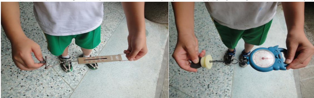
圖十一 一手握住磁鐵，另一手握住彈簧秤測量情形
