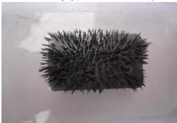
圖三、長方形磁鐵的磁力線分佈全面均勻 圖四、長方形磁鐵的磁力全面均勻 結果：長方形磁鐵的磁力線分佈全面均勻，如圖三；磁力一樣大，如圖四。
