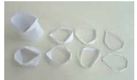
圖 6-5 實驗後紙柱被壓扁的樣子
