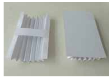
圖 4-3： 左-7 摺只黏貼中間紙條 (反面) 右-7 摺加底面黏貼兩邊 (反面)
