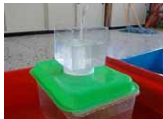
圖 6-4 高 2.5 cm 紙柱實驗情形
