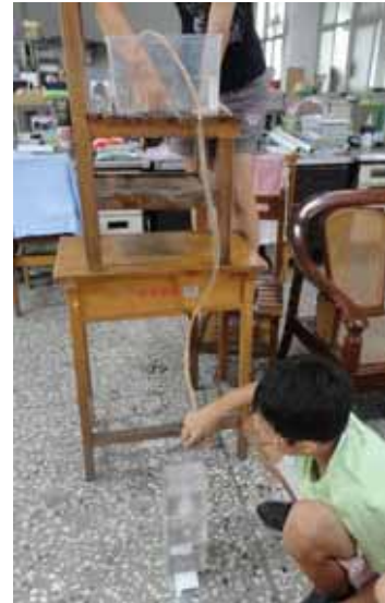
圖 3-7 利用虹吸原理讓水自然流出，減少手的影響
