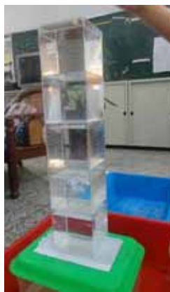
圖 4-7：7 摺加底面黏貼兩邊固定的實驗情形
