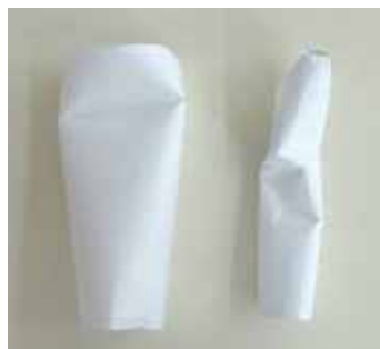
圖 5-8 實驗後的空心圓柱
