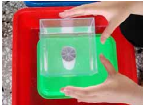
圖 5-3 小圓柱加米字放射狀柱體實驗
