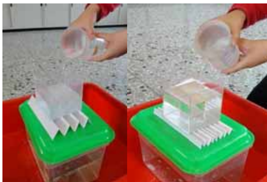
圖 1-2 方形量杯放在紙上、紙放在實驗平盤上、平盤置於水箱上，下面紅色大水箱是用來接方形量杯倒下時的水（左邊實驗的是 4 摺圖畫紙；右邊是 8 摺圖畫紙）
