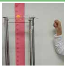
圖 6-7 拉動袋針同時觀測及拍攝乒乓球的彈跳高度。
