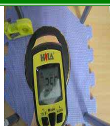
圖 7-3 使用水平尺及紅外線溫度感應器測試水平及溫度
