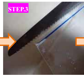
圖 3-3 配合袋針的長度裁切適當長度的壓克力條。
