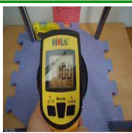
圖 6-6 以紅外線溫度感應器測量溫度。
