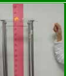
圖 7-4 拉動袋針同時觀測及拍攝乒乓球的彈跳高度
