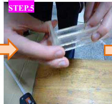
圖 3-5 用熱熔槍將長、短壓克力條黏合，組合出袋針軌道。
