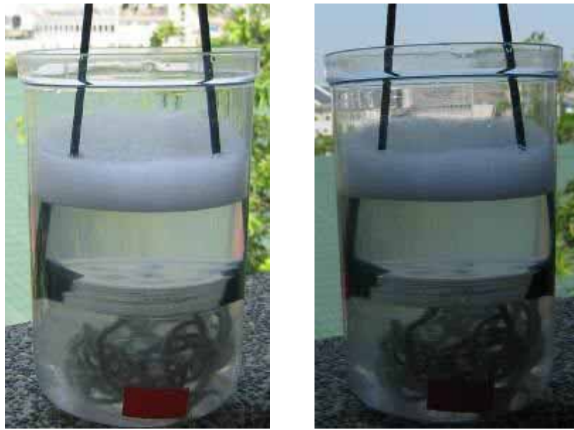
圖 20 洗衣內槽下降模擬情形
