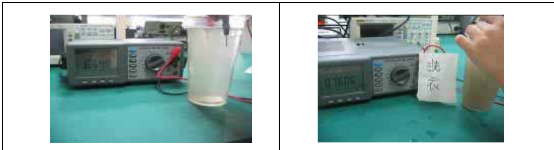
圖 9 測水之電阻值
