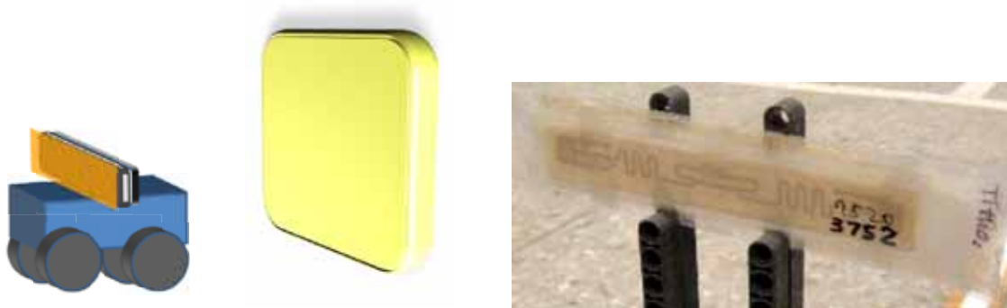
圖 6.2 靜態測試平台及後面有中間層及隔離層之標籤
