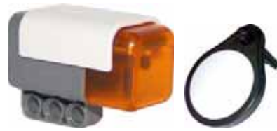
圖 2.4 低頻 RFID 讀取器及識別標籤 (CODATEX, 2011)
