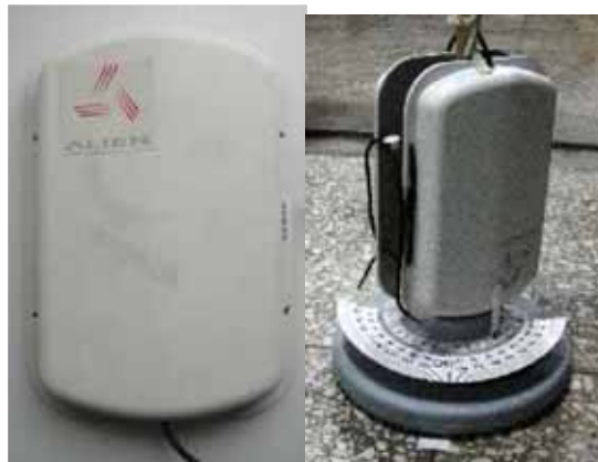
圖 2.6 RFID 915 MHz 圓極/線極天線
