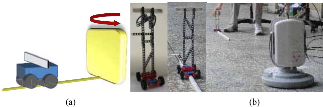
圖 2.8 距離角度靜態測試平台；(a) 平台設計圖；(b) 測試平台實體圖
