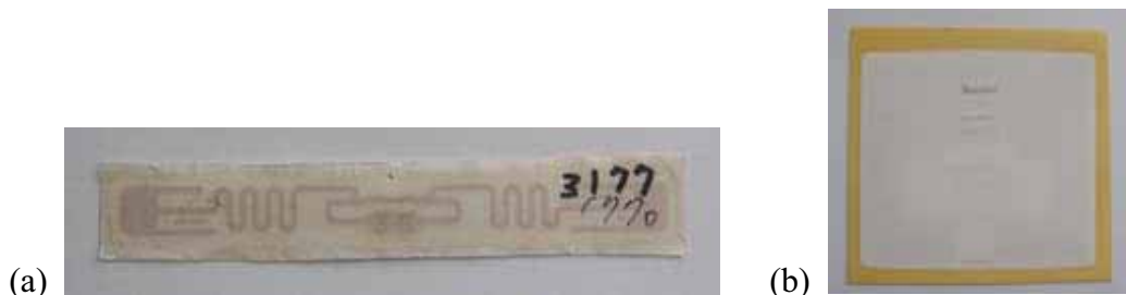
圖 2.7 RFID UHF 識別標籤 (a) ALL-9540 標籤 (b) ALL-9534 標籤
