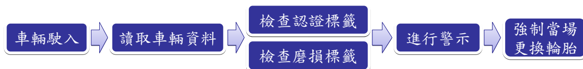
圖 7.13 輪胎檢查系統之工作原理流程圖
