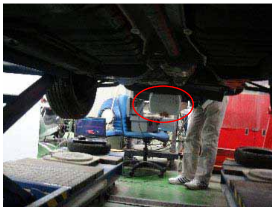
圖 7.8 天線分別由前保險桿下及車底盤正中央讀取 RFID 標籤
