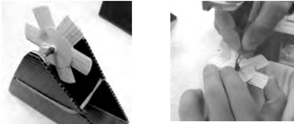
圖 8. (左) 質心調整台；(右) 切去部份扇葉盤的重量調整質心
