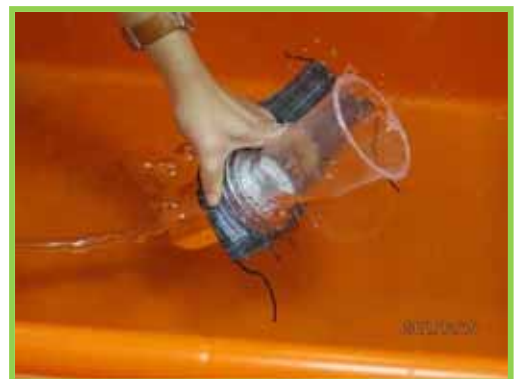
圖 5 利用水槽測試改裝之密封罐，是否可讓氣體完全通過口罩
