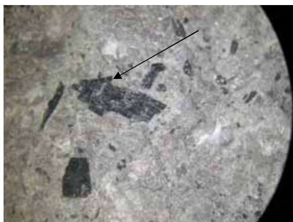
圖 25 有部分柱狀結晶受力錯開(40X)
