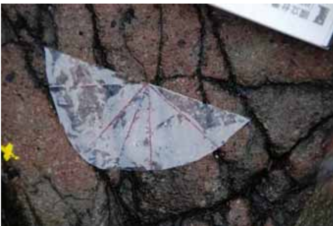
圖 10 自製方位測量膜
