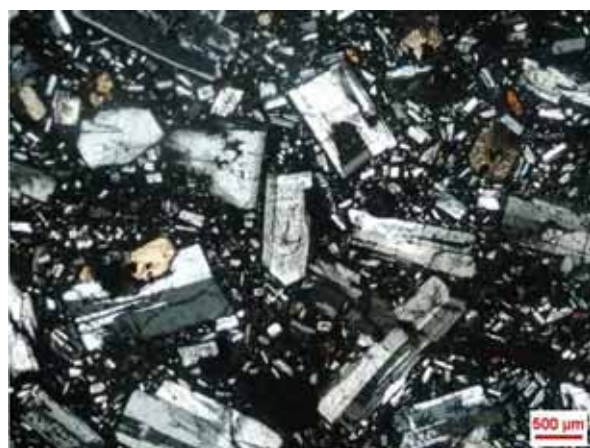
圖 28 偏光顯微鏡下（正交偏光）可見安山岩主要由斜長石組成，少數之暗色礦物以角閃石及輝石為主
