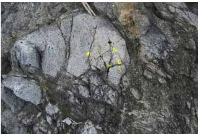
圖 15 礫石破碎情形複雜，無特定的裂痕方向(圖中黃色三點各相距 8 公分，N 點和另兩點的中點連線方向即指向南)
