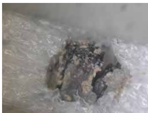
圖 41 擠壓後破碎的角閃石結晶
