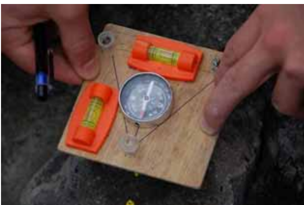
圖 6 自製定向採樣器
