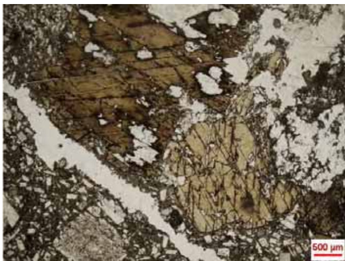
圖 26 偏光顯微鏡下（平行偏光）安山岩（左下）及富角閃石團塊（右上）
