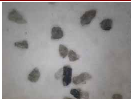
圖 22 顯微鏡下的安山岩顆粒(0.297~0.210mm)，圖中的黑色顆粒為角閃石(放大倍率 40X)
