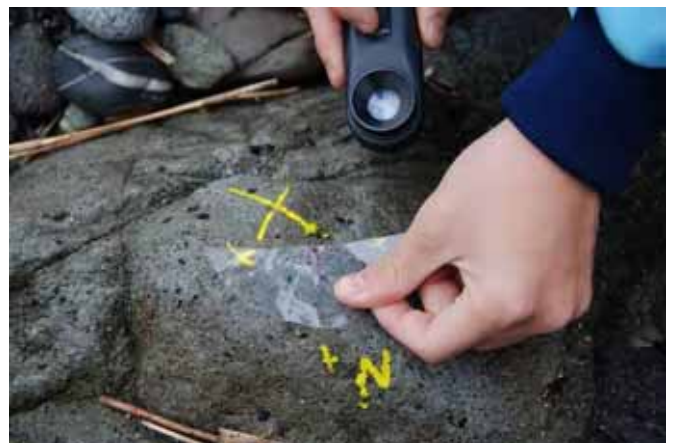
圖 11 90^\circ 對準 N，以測出裂痕方位
