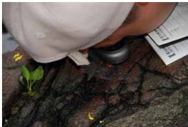
圖 12 用放大鏡觀察裂痕方位
