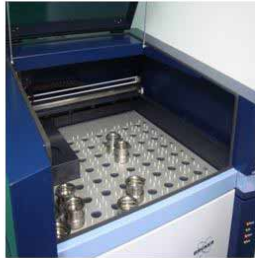
圖 4-37 將樣本放入 XRF 的樣本臺
