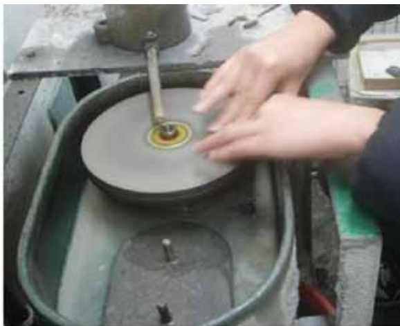
圖 4-27 將玻片上的岩石磨到可透光為止
