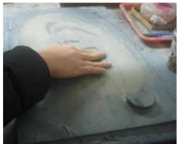
圖 4-28 用 1500 mesh 的金剛砂手動磨片
