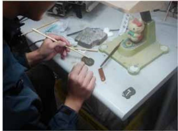
圖 4-26 用加拿大膠黏著岩石平整面與載玻片
