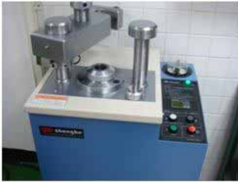
圖 4-36 製作樣本餅的儀器
