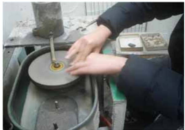
圖 4-24 將岩石拋光出平整的光滑面
