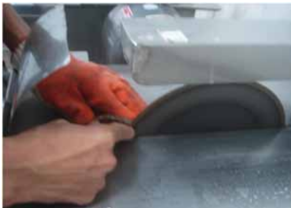
圖 4-23 用鋸片機將岩石切薄
