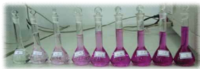
圖一(1)： \text{Cr}^{6+}_{(\text{aq})} 之檢量線(圖左)、 \text{Cr}_2\text{O}_7^{2-}_{(\text{aq})} 全譜(圖右)及檢量試樣(圖下)
