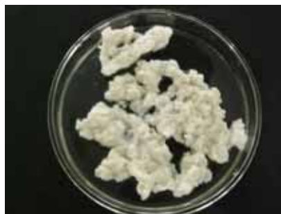
圖四(二)：乾式粉末狀幾丁聚醣- \gamma -PGA 複合材料對 \text{Cr}^{6+} 、 \text{Cu}^{2+} 之吸附效果
